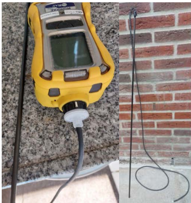
Figuur 2. Foto links: Multi-RAE met filter en aansluiting monstername-unit; foto rechts: Sonde met slang.
